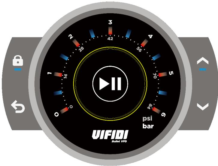
**Tlačítko nahoru** – stiskem zvýšte požadovaný tlak v systému až na 6 bar.
