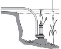
Во избежание преждевременного износа насоса-при его использовании в пруду или реке-установить насос на ровном возвышении, чтобы насос не засасывал песок или мелкие камни. При использовании в качестве подающей трубы шланга или пластмассовой трубы используйте предохранительный трос или цепь для опускания, крепления и поднятия насоса.
