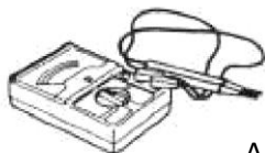
Вольтметр переменного тока
