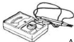
Вольтметр переменного тока
