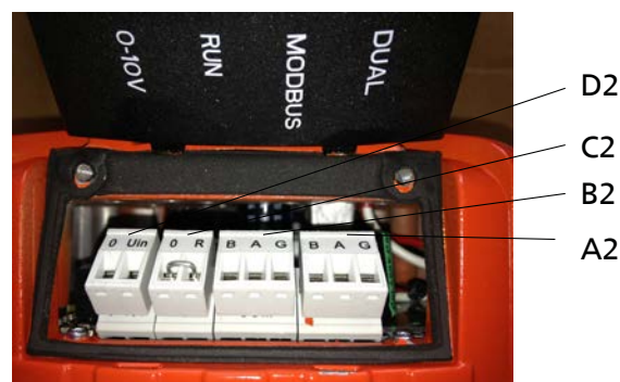
Obr. 7: Připojovací prostor pro datový kabel
