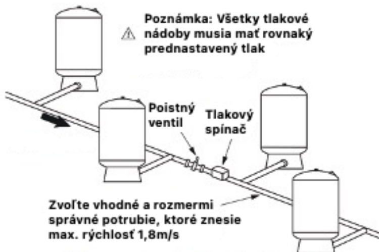
Obr. 1.5 Inštalácia viacerých tlakových nádob
