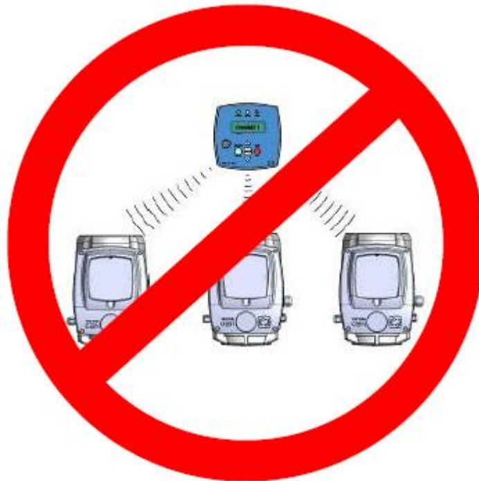
Obrázek 26: Jedním tlačítkovým ovladačem KEYPAD nelze ovládat více motorů na jednom kanálu
