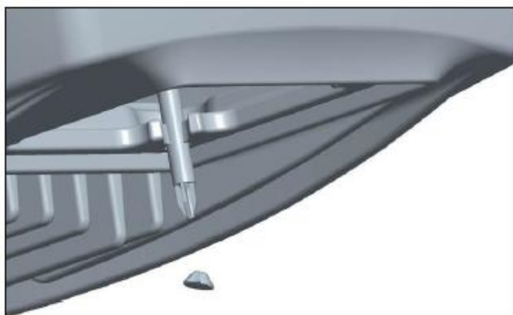
Obrázek 12: Odstranění kovových pilin.
